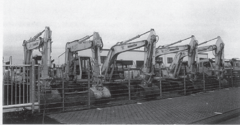
Ketten und Mobilbagger
